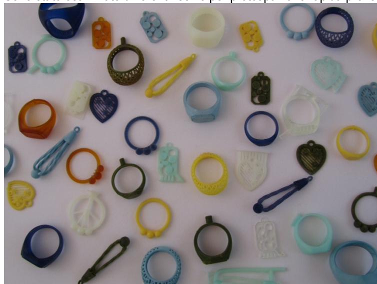
Fig. 1 Esempio di oggetti prodotti in resina tramite processi di prototipazione rapida con metodologie differenti
