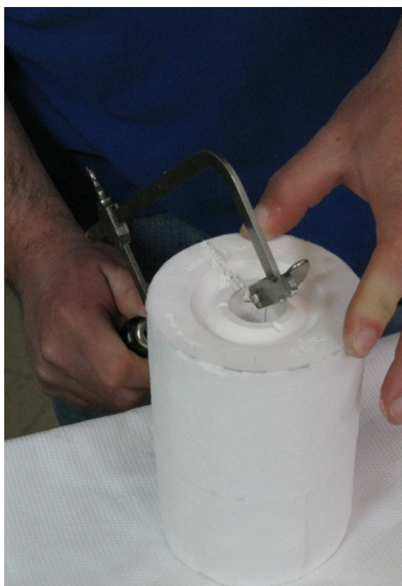
Fig. 15 Apertura del rivestimento dopo calcinazione (a) ed esempio di cavità (b).
