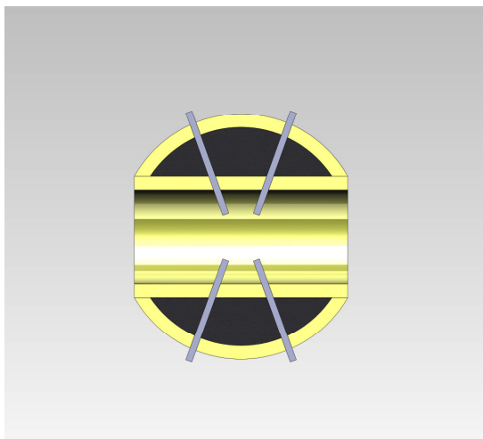
Figura 9. Il calco rimosso dal manico di legno (mandrino) con dei tasselli installati per evitare che l'anima si muova.
