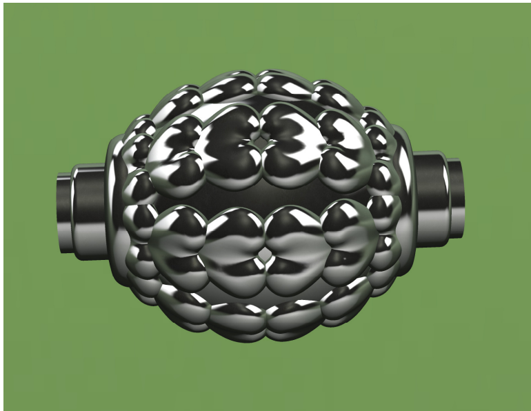
Figura 20. Il modello master per il calco di fusione deve avere l'anima al suo interno con degli elementi localizzatori.
