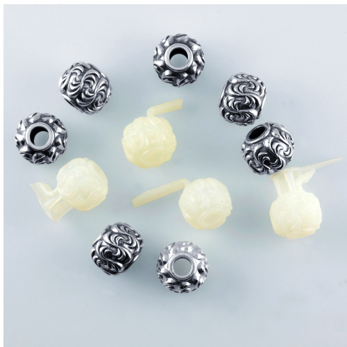
Figura 18. Modello in resina sviluppato con la stereolitografia per la fusione diretta.
